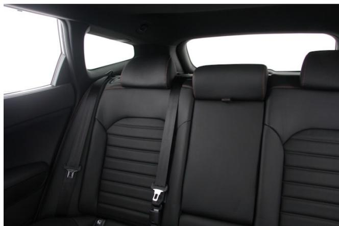
Nicht versenkbaren Kopfstützen sowie eine hohe Fensterlinie beeinträchtigen die Sicht nach schräg hinten.
