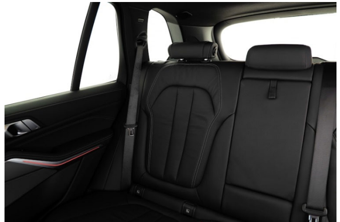
Breite Dachsäulen und nicht versenkbare Kopfstützen verhindern eine akzeptable Sicht nach hinten.
