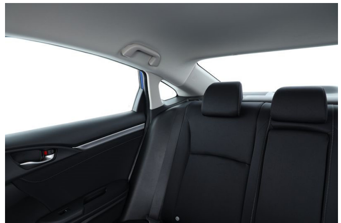
Breite Dachsäulen und nicht vollständig versenkbare Kopfstützen schränken die Übersichtlichkeit erheblich ein.
