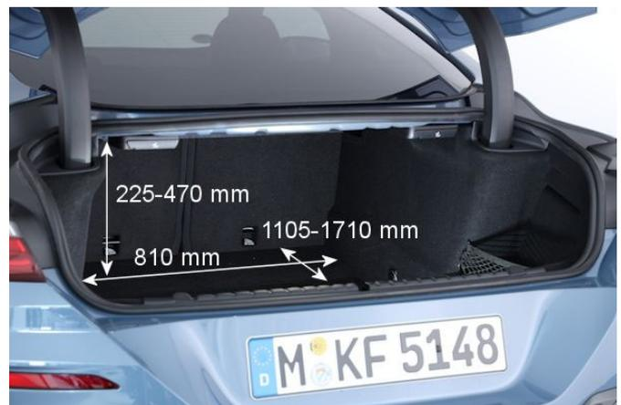
Mit 375 l ist der Kofferraum für ein Coupé angemessen groß, die Funktionalität leidet jedoch unter der kleinen Ladeöffnung und der hohen Ladekante.
