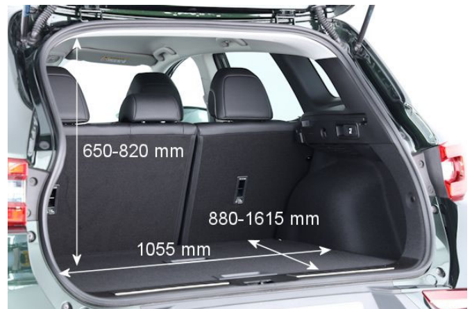
Mit 390 l Volumen ist der Kofferraum des Kadjar von klassenüblicher Größe. Störend ist die relativ hohe Ladekante.
