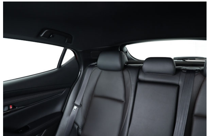
Die breiten Dachsäulen und die hoch angesetzten, schmalen Fenster schränken die Sicht nach hinten erheblich ein.
