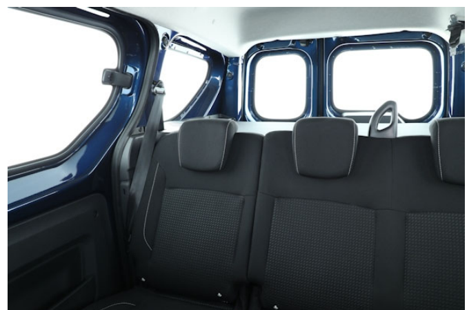
Die Sicht nach schräg hinten wird durch breite Dachsäulen und die geteilte Hecktür eingeschränkt.
