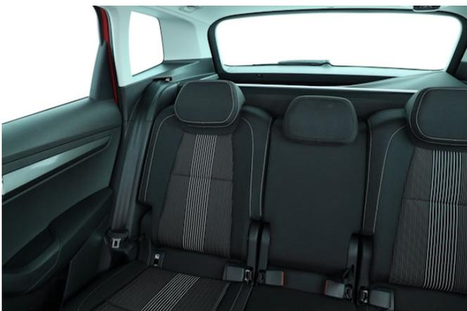
Die teilversenkbaren Kopfstützen und nicht allzu breiten Dachsäulen sorgen für eine zufriedenstellende Rundumsicht auch nach hinten.
