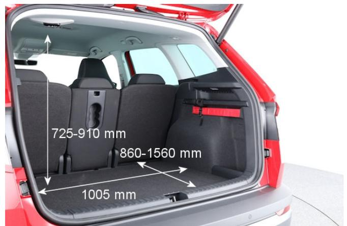
Mit 360 l Volumen bietet der Kofferraum des Allrad-Karoq deutlich weniger Platz für das Gepäck als die frontangetriebene Version (430 l).
