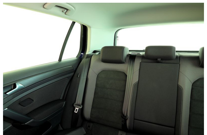
Trotz teilversenkbarer Fondkopfstützen ist die Sicht nach schräg hinten aufgrund der sehr breiten Dachsäulen stark eingeschränkt.
