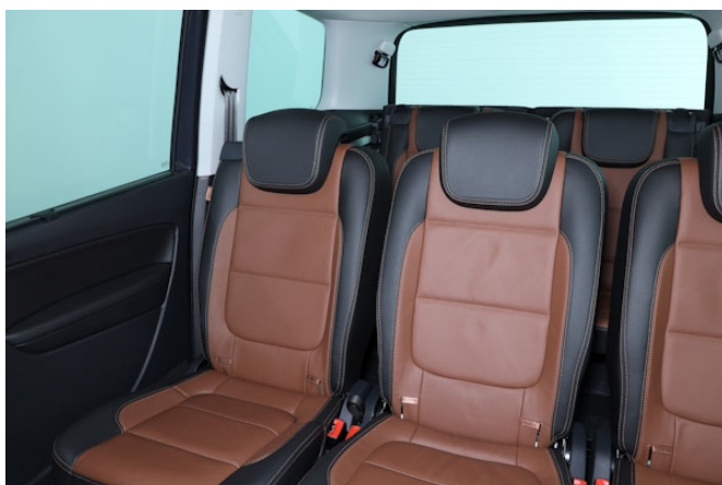
Versenkbare Kopfstützen und nicht all zu breite Dachsäulen erleichtern die Sicht nach hinten.
