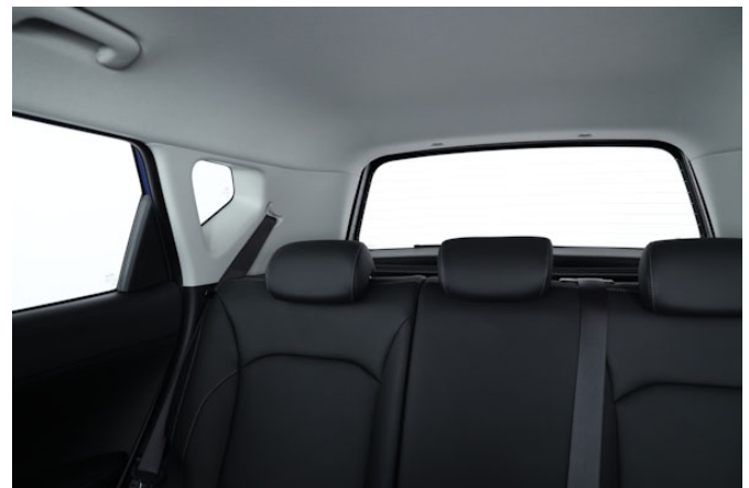
Die besonders breiten Dachsäulen schränken den Blick nach schräg hinten erheblich ein.
