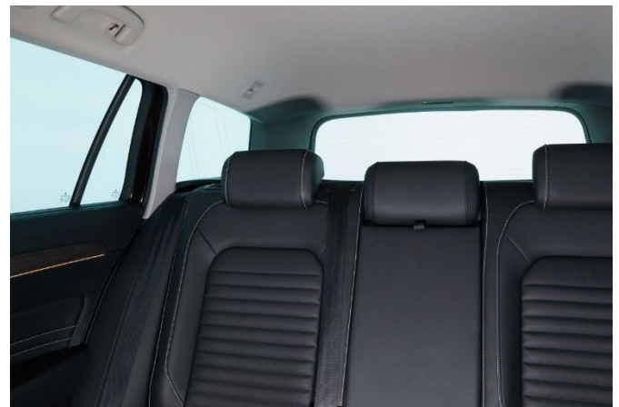
Breite Dachsäulen und nicht voll versenkbare Kopfstützen im Fond erschweren die Sicht nach schräg hinten.
