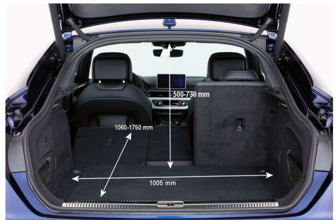
Der Gastank unter dem Heck verringert das Kofferraumvolumen auf 295 l im Vergleich zu den konventionellen Modellen (360 l).
