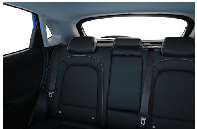
Die breiten Dachsäulen und nicht versenkbaren Kopfstützen im Fond schränken die Sicht nach schräg hinten erheblich ein.
