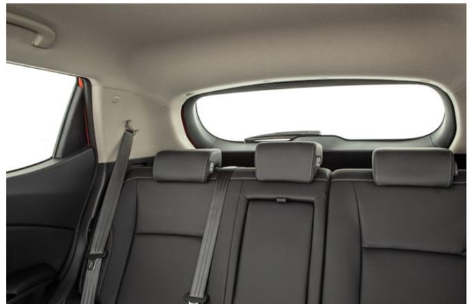
Die sehr breiten Dachsäulen und die schmale, hoch angesetzte Heckscheibe schränken die Sicht nach hinten erheblich ein.
