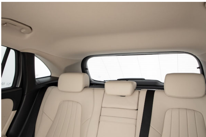
Breite Dachsäulen und die nur teilweise versenkbaren Fondkopfstützen schränken die Sicht nach hinten ein.
