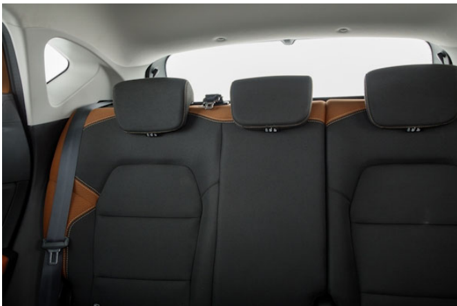
Die breiten Dachsäulen und nicht versenkbare Kopfstützen behindern die Sicht nach hinten sehr stark.
