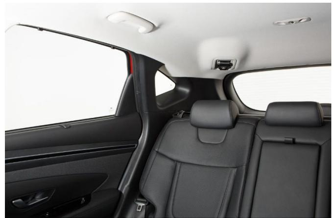
Die sehr breiten Dachsäulen und die schmale, hoch angesetzte Heckscheibe schränken die Sicht nach schräg hinten erheblich ein.
