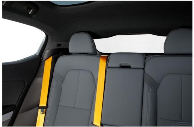
Sehr breite Dachsäulen und nicht versenkbare Kopfstützen schränken die Sicht nach hinten erheblich ein.
