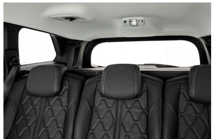
Die breiten Dachsäulen und das hoch angesetzte, schmale Heckfenster schränken die Sicht nach hinten erheblich ein.
