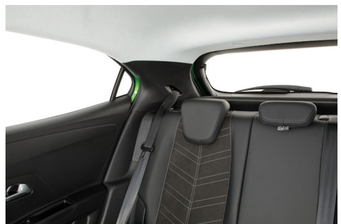
Die breiten Dachsäulen schränken die Sicht nach schräg hinten stark ein.
