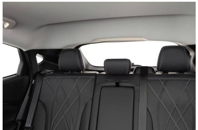
Breite Dachsäulen und nicht versenkbare Kopfstützen schränken die Sicht nach hinten erheblich ein
