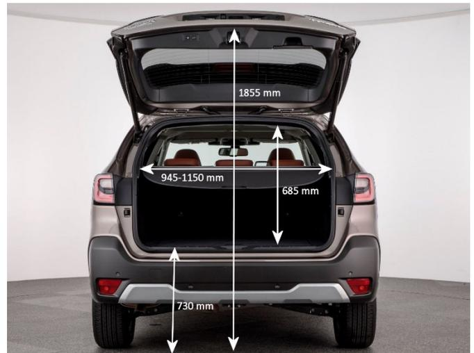
Die Heckklappe öffnet ausreichend weit, aber am abstehenden Schloss besteht die Gefahr, sich den Kopf zu stoßen. Mit 73 cm liegt die Ladekante des Subaru Outback relativ hoch über der Straße.
