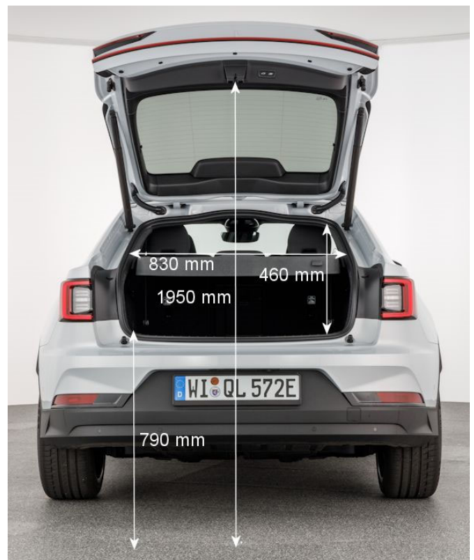
Mit einer Höhe von 79 cm macht die Ladekante das Be- und Entladen zu einer Mühsamen Arbeit.
