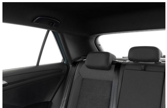
**Breite Dachsäulen und nicht vollständig versenkbare Kopfstützen schränken die Sicht nach hinten erheblich ein.**
