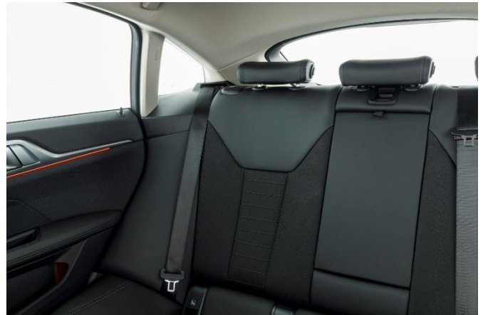
Die Sicht nach hinten ist aufgrund der breiten Dachsäulen und der hohen Fensterlinie stark eingeschränkt.
