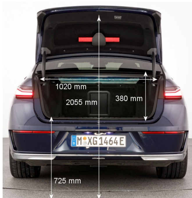
Die ca. 73 cm hohe Ladekante macht das Be- und Entladen des Kofferraums zu einer mühsamen Tätigkeit.
