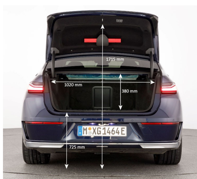
Die ca. 73 cm hohe Ladekante macht das Be- und Entladen des Kofferraums zu einer mühsamen Tätigkeit.
