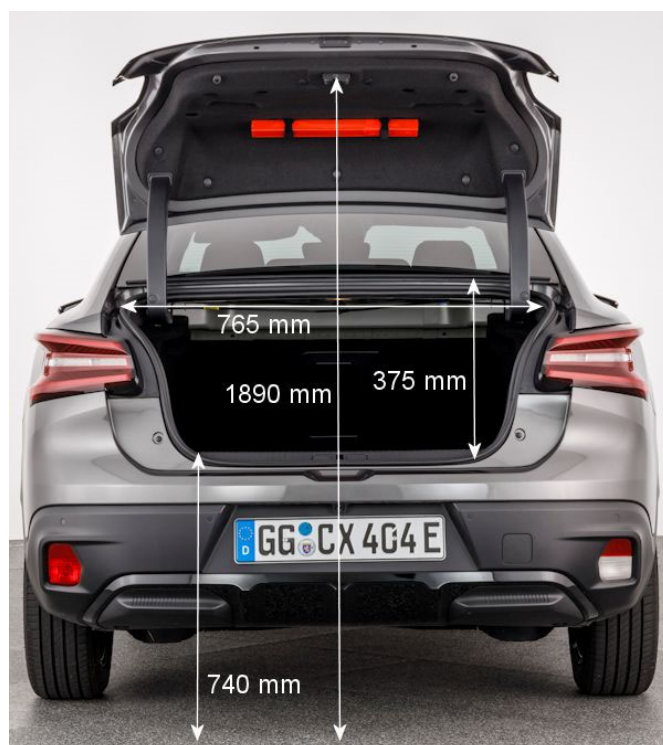
Die Ladekante mit einer Höhe von 74 cm bereitet beim Be- und Entladen des Kofferraums so gut wie keine Probleme.
