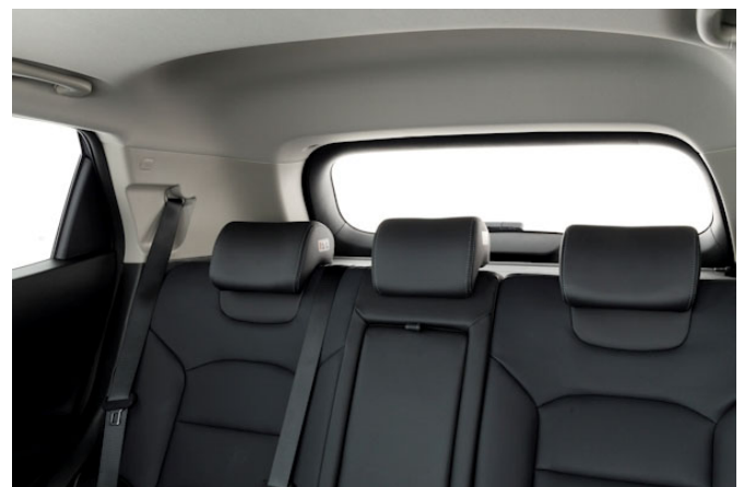
Die sehr breiten Dachsäulen und die hoch angesetzte, schmale Heckscheibe schränken die Sicht nach hinten erheblich ein.
