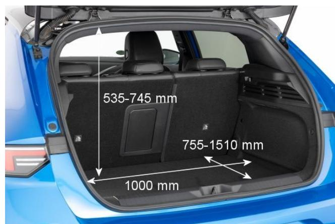
Der verbaute Akku reduziert das Kofferraumvolumen auf 260 l gegenüber den konventionell angetriebenen Modellen (305 l).
