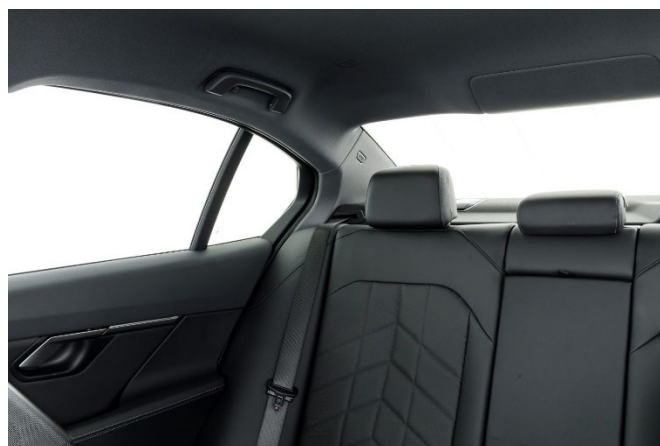
Neben den breiten Dachsäulen stören die nicht versenkbaren Kopfstützen die Sicht nach hinten.
