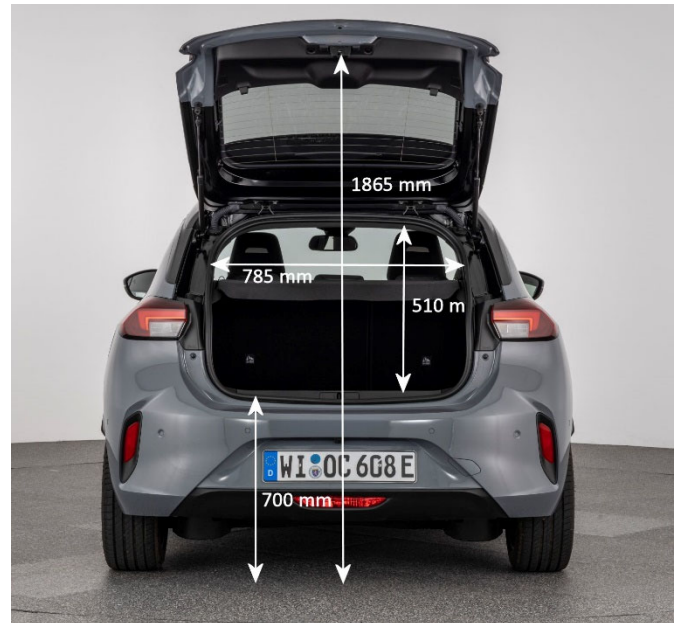
Die Ladekante liegt 70 cm über der Straße, praktikabel für's Beladen. Die 18-cm-Stufe innen stört aber beim Ausladen.
