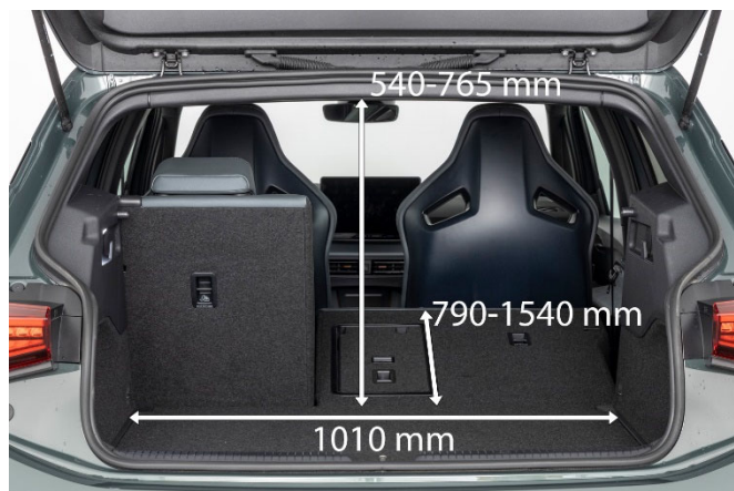
Das Kofferraumvolumen variiert von 315 Litern mit variablem Boden in unterer Position bis maximal 1.195 Litern bei umgeklappter Rückbank und Beladung bis zum Dach.
