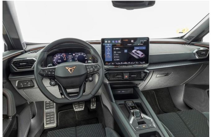
Das Facelift des Formentor beinhaltet eine beleuchtete Touch-Leiste und ein größeres Zentralsdisplay, während die Bedienung insgesamt durch tiefgehende Menüstrukturen und die Platzierung der Starttaste am Lenkrad weiterhin Optimierungspotenzial aufweist.
