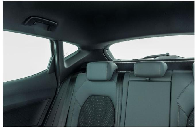
Die Rundumsicht ist eingeschränkt, vor allem nach schräg hinten. Serienmäßige Einparkhilfen und eine 360-Grad-Kamera helfen.
