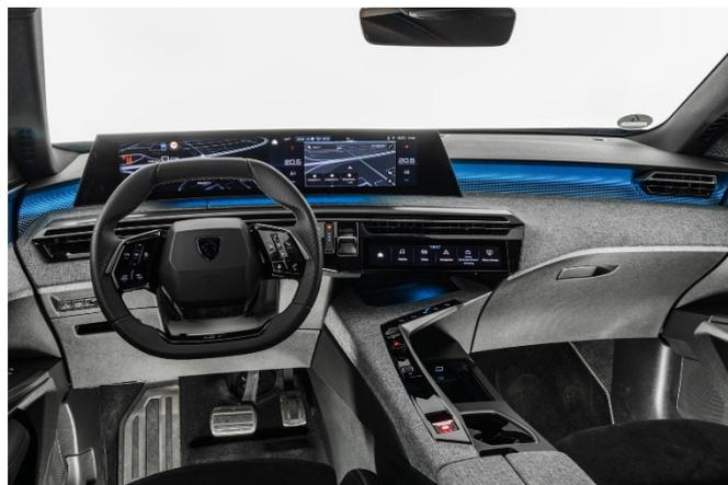
Peugeot setzt beim 5008 auf das weiterentwickelte i-Cockpit mit großflächigen Displays und einer ungewöhnlichen Anordnung von Lenkrad und Instrumenten, deren Bedienung Eingewöhnung erfordert und teilweise ergonomische Mängel aufweist.
