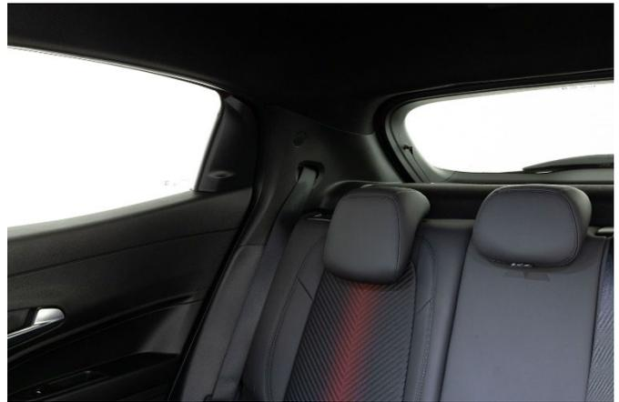
Breite C-Säulen und die schmale, hoch positionierte Heckscheibe erschweren die Sicht nach hinten deutlich.
