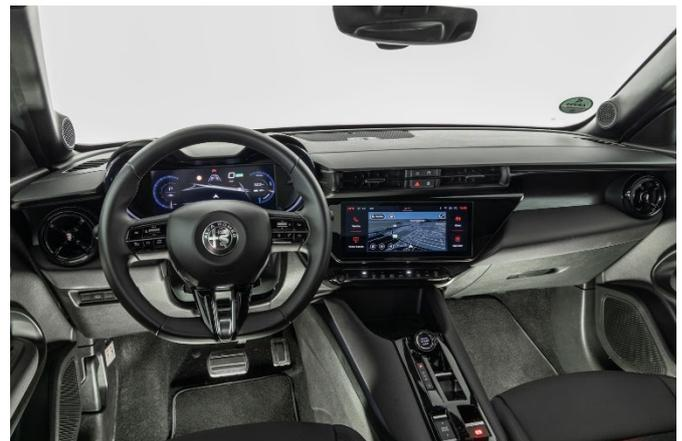
Die Klimabedieneinheit ist zu niedrig unter dem Zentralsdisplay positioniert, gleich neben dem Dreh-Drück-Steller für das Audiosystem, welcher leider unbeleuchtet und somit bei Nachtfahrten nur schwer zu bedienen ist.
