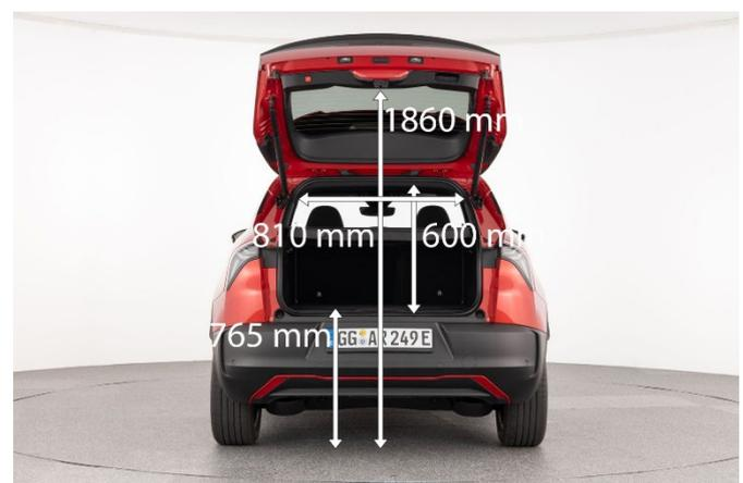
Die Ladekante fällt mit knapp 76 cm ziemlich hoch aus und erschwert damit das Beladen mit gewichtigen Gütern. Die elektrische Heckklappe schwenkt rund 1,85 m hoch.
