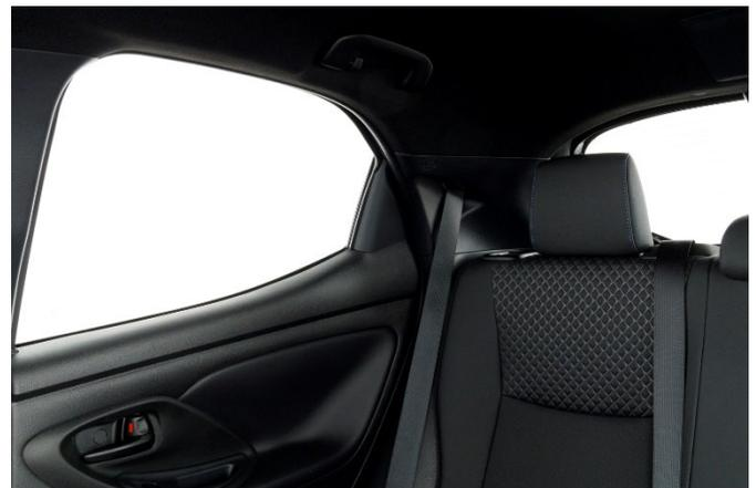
Die Sicht nach hinten im Yaris ist u. a. durch die hohe Heckscheibe eingeschränkt, wird jedoch durch eine serienmäßige Rückfahrkamera verbessert. Der fehlende asphärische Bereich der Außenspiegel erschwert die Überwachung des toten Winkels. [Abb. ähnlich]
