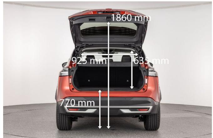
Der Kofferraumboden ist zweigeteilt und höhenstellbar. Die breite Kofferraumöffnung erleichtert das Beladen, die hohe Ladekante von 77 cm dagegen nicht.
