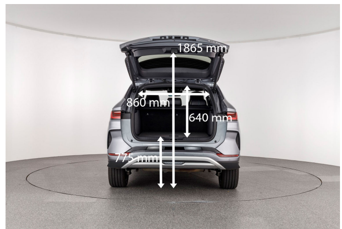
Die Heckklappe öffnet elektrisch angetrieben rund 1,85 m hoch. Mit einer Ladekante von 78 cm wird das Beladen schwerer Gegenstände umständlicher.
