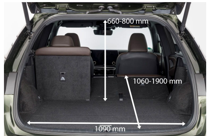
Das Ladevolumen beträgt 505 bis maximal 1.495 Liter. Weitere 35 Liter gehen unter den Ladeboden.
