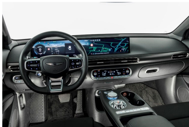
Der Genesis GV60 kombiniert physische Bedienelemente und einen zentralen Touchscreen, der optional über einen Dreh-Drück-Steller steuerbar ist.
