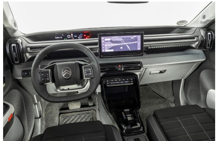
Der C3 bietet ein flaches Instrumenten-Display unter der Windschutzscheibe sowie einen 10,25 Zoll Touchscreen für die zahlreichen Einstellmöglichkeiten. Praktisch: Die Klimasteuerung erfolgt über ein eigenes Bedienfeld mit physischen Tasten.
