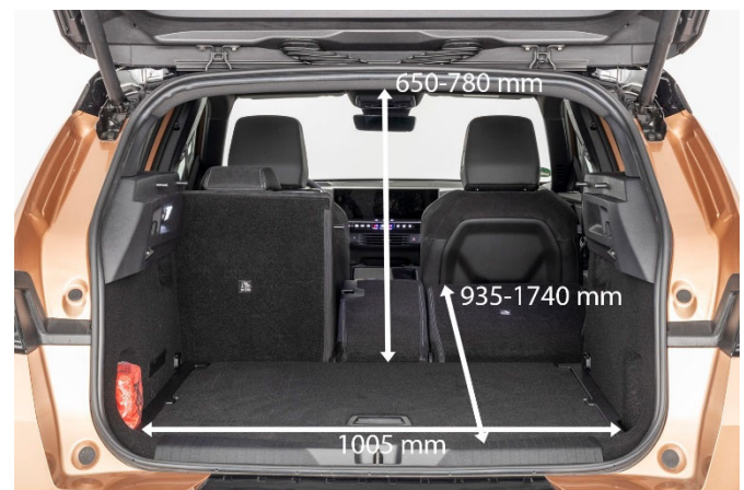
Das Kofferraumvolumen des Opel beträgt 425 bis maximal 1.460 Liter.
