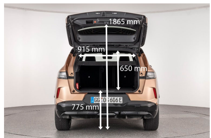
Der Opel verfügt über eine sensorgesteuerte, elektrische Heckklappe. Mit gut 78 cm liegt die Ladekante ziemlich hoch über dem Boden.
