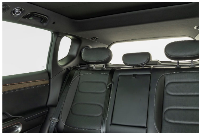
Die Rundumsicht wird vor allem durch die breiten D-Säulen und die nicht versenkbaren Fondkopfstützen beeinträchtigt.
