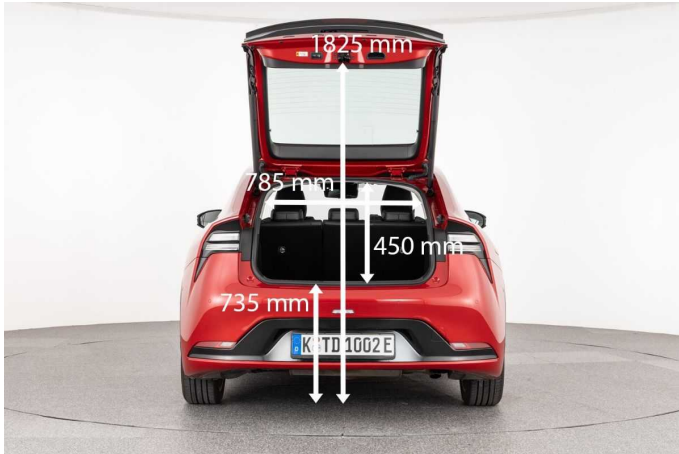
Die elektrische Heckklappe öffnet weit und gibt eine große Öffnung frei. Die Höhe der Ladekante beträgt 74 cm, innen liegt die Stufe bei 7
