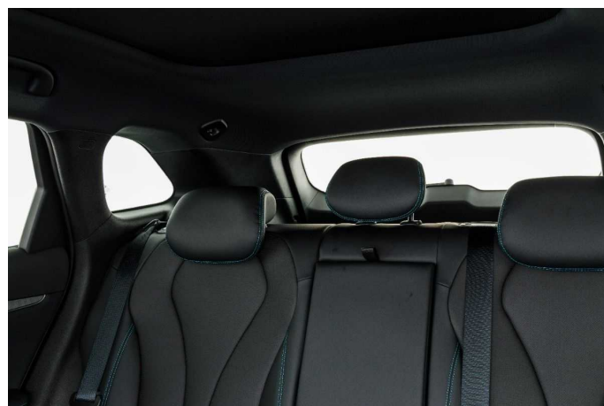
Die Sicht nach hinten wird vor allem durch die breiten Dachsäulen, die hoch liegende Heckscheibe und die Kopfstützen behindert.
