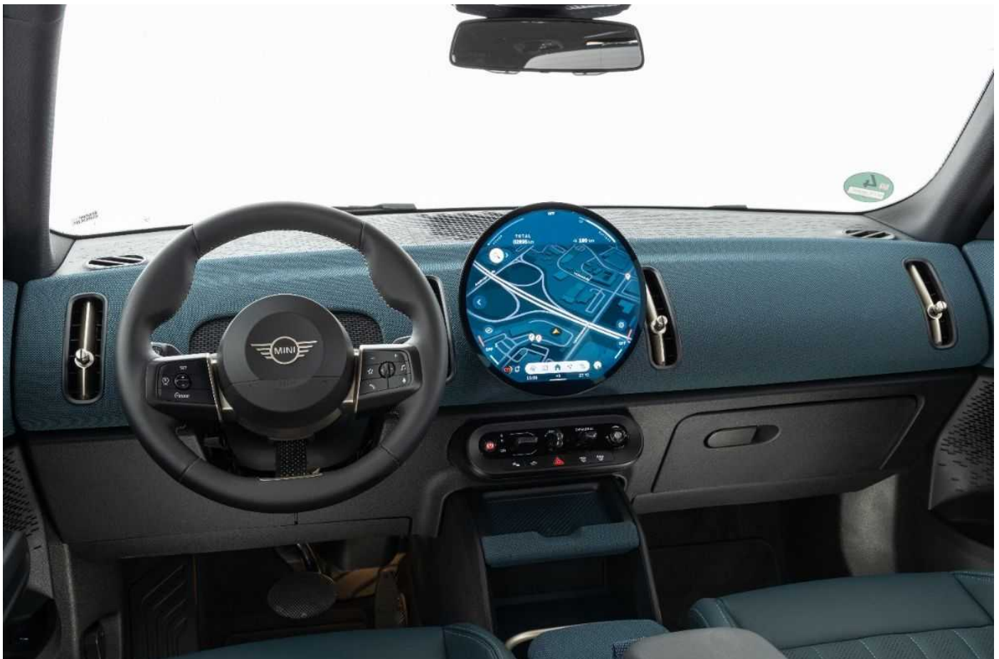
Mini bündelt nahezu alle Bedienfunktionen im zentralen 24-cm-OLED-Touchdisplay. Dies lenkt beim Fahren stark ab.
