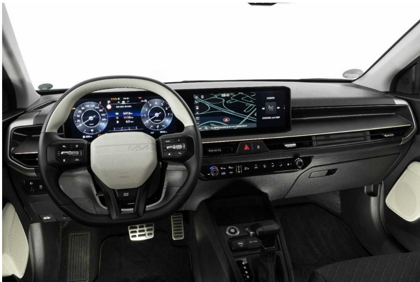
Das Infotainment wird vorrangig über Toucheingaben bedient. Wichtige Funktionen sind als haptische Tasten ausgeführt.
