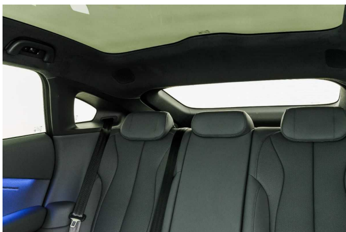
Die Rundumsicht ist nur ausreichend, da breite Dachsäulen und die nicht vollständig versenkbaren Kopfstützen die Sicht einschränken.
